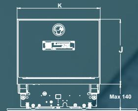
**Mit** Hebe-Senk-Automatik ruht die Verkleidung auf dem Boden und hebt sich bis zu 140 mm. Diese Position kann auf verschiedene Höhen eingestellt werden.
