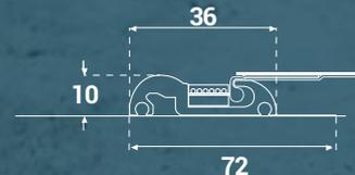
Um kleine Unebenheiten des Untergrunds auszugleichen, wird bei Weichholz, Vollverbundstoff (WPC), Pflaster- und Klinkersteinen die breite Laufschiene mit 72 mm vorausgesetzt.
