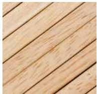
Hartholz ( p > 650 \text{ kg/m}^3 ) ( p = \text{Dichte} )
